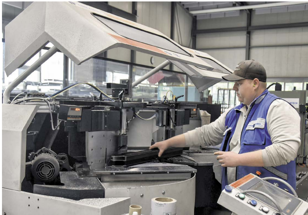
Lukas Grüter schneidet an der angesteuerten Doppelgehrungssäge isolierte Aluprofile zu.
