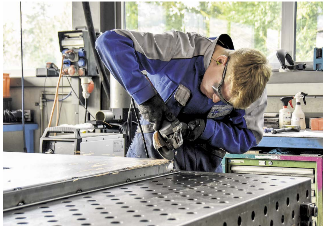
Silvan Jost beim Verarbeiten und Zusammenbau von Stahlblechtüren. Fotos David Koller
