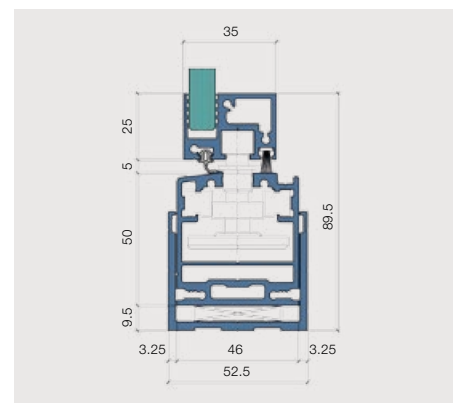
Detail unten mit Ausgleichsprofil
