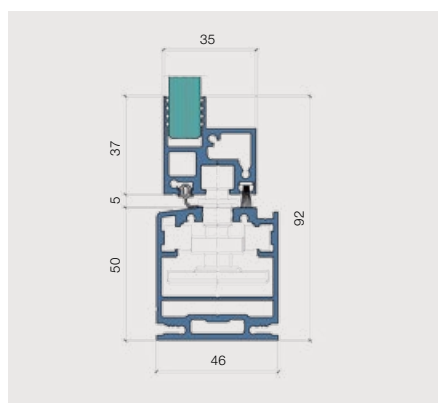
Detail unten mit 12 mm Glas
