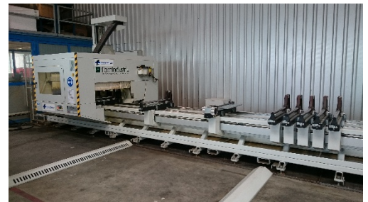
Maschine, welche die Bohrungen durchführte
